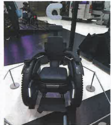
電動車いす JUU 乗降アシスト機能で安全。凹凸道路や階段やスロープも昇降。スマホでの操作も可能。参考出品（トヨタ自動車）
