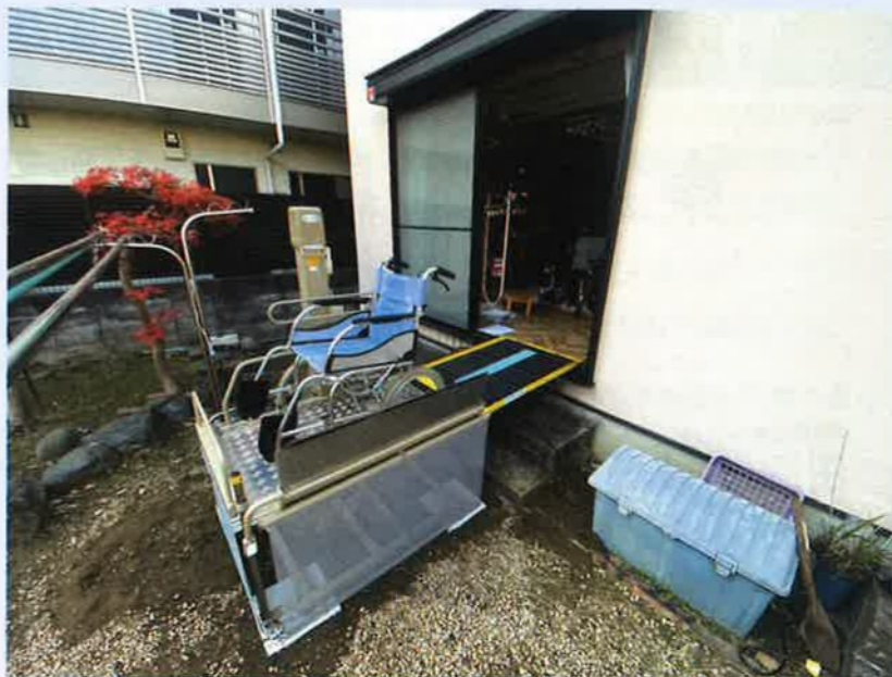
▶② こちらは寝室で車いすに乗り、そのままスロープと電動昇降機（くりはリフト）を使って、掃き出し窓から1人介助で外出しているパターン。
